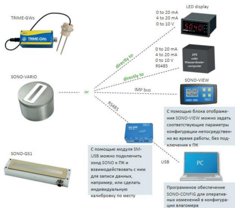
Рис.1.Схема подключение датчиков SONO-VARIO.
